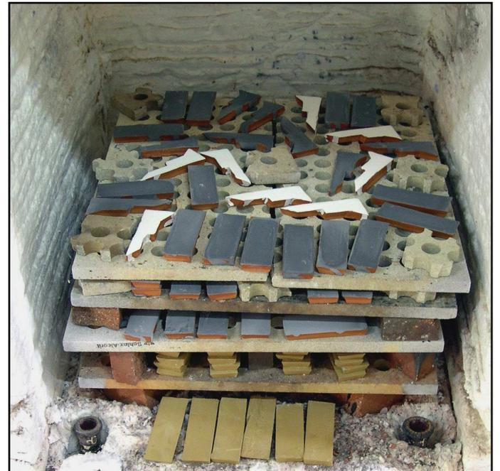
Pour la cuisson, un étage ou deux de terre est disposé dans le bas du four avec, au dessus, plusieurs étages de zelliges à émailler :
