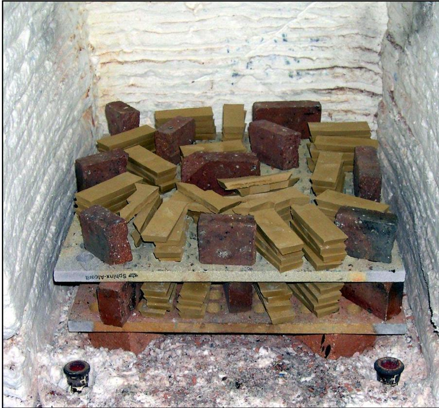
La terre découpée et séchée est rangée dans le bas du four, là où la température est la plus basse, en laissant l'air chaud circuler librement entre les paquets et les supports. En général la cuisson est mixte ; au dessus, les zelliges à émailler et encore au dessus les gazettes de carreaux.
