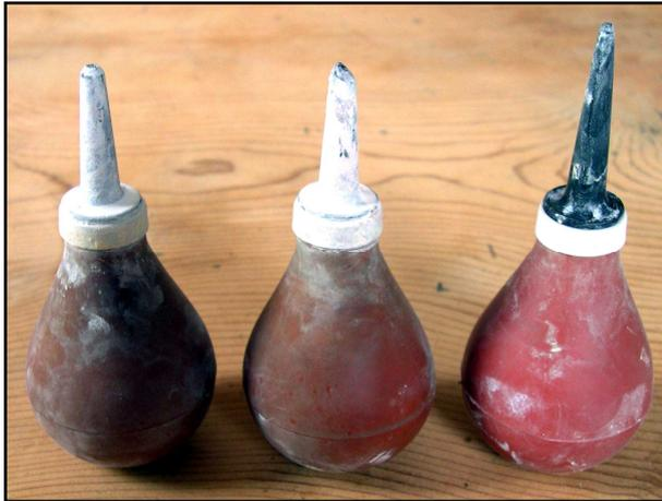
Les pinceaux n'ont pas de réserve suffisante pour déposer la quantité d'émail nécessaire sur une grande surface. La poire, par pression de la paume, permet de déposer une couche d'émail importante jusqu'à 0,4 mm d'épaisseur.
