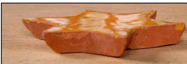
L'ensemble est mis à sécher sur des claies dans un endroit bien ventilé ou dans le four à une température inférieure à 100 °. La terre blanchit progressivement.
