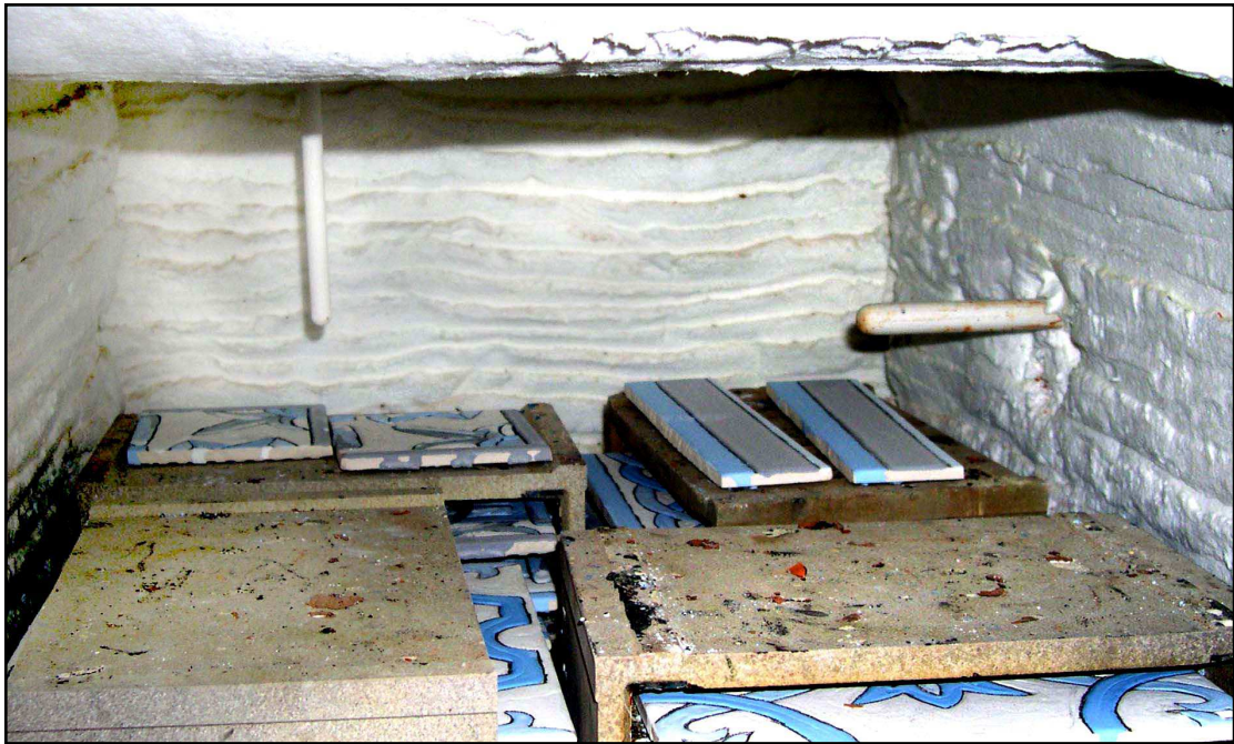
Position des deux sondes pyrotechniques dans le four.
