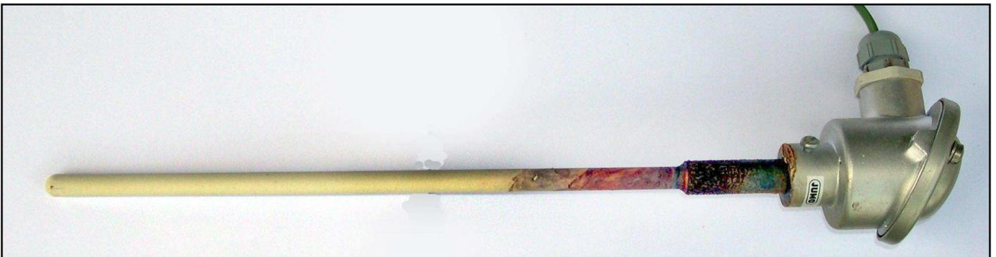
La température est mesurée par deux sondes à thermocouple situées une en haut et l'autre à mi-hauteur.
